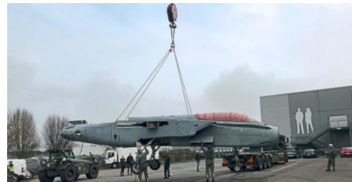
Mit einem Spezialkran wird der Rumpf des Tornados vor der Messehalle 20 vom Transporter gehievt. Dann werden die Fahrwerke ausgefahren, damit der Rumpf darauf gestellt werden kann.
