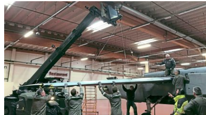
Auch in der Messehalle in Bad Salzuflen geht nichts ohne Kran. Mit einem bundeswehreigenen Gerät wird die Tragfläche an den Rumpf gehoben. Mit vereinten Kräften schieben die Soldaten der Luftwaffe aus Kaufbeuren die Tragfläche dann an den Flieger, damit er hier angeschraubt werden kann.
